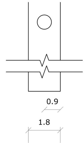
Las perforaciones en los cantos de los tableros de 18 mm siempre deben ir al centro de estos, como se indica en la imagen adjunta
