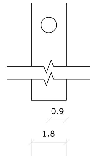
Las perforaciones en los cantos de los tableros de 18 mm siempre deben ir al centro de estos, como se indica en la imagen adjunta
